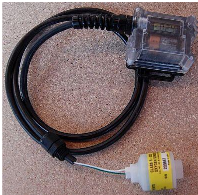
Abbildung 3: Komplet System: O 2 -Sensor mit Display
